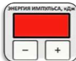
Рисунок 28 Кнопки установки и индикатор значения энергии импульса, подводимой к сейсмическому источнику
