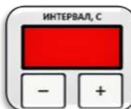
Рисунок 29 Кнопки установки и индикатор интервала импульсов
