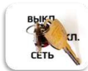
Рисунок 25 Ключ включения питания в выключенном положении
