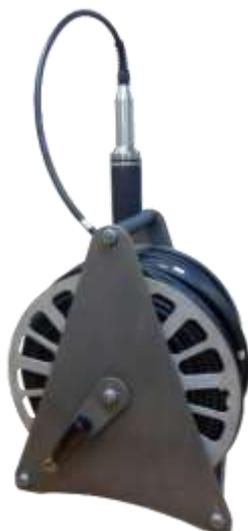
Рисунок 5 Скважинный источник поперечных волн Pulse
