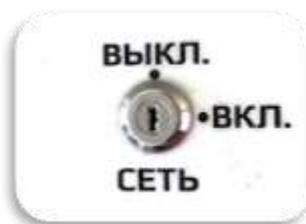
Рисунок 24 Замок для включения питания
