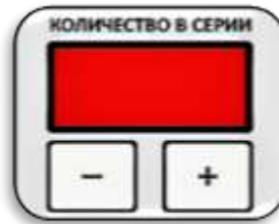
Рисунок 30 Кнопки установки и индикатор количества импульсов в серии
