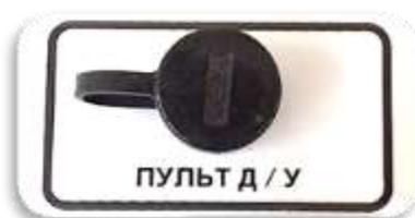
Рисунок 9 Разъём для подключения пульта дистанционного управления
