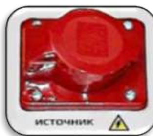
Рисунок 8 Высоковольтный разъем для подключения сейсмического источника
