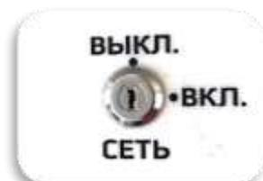
Рисунок 14 Замок для включения питания
